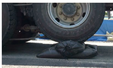
縮災土のう(45軸の繰り返し)
