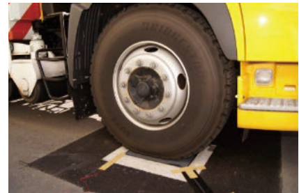
車両踏付試験状況
