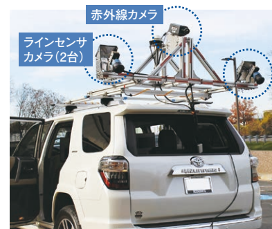
■ 橋梁点検時の使用機器(米国)
