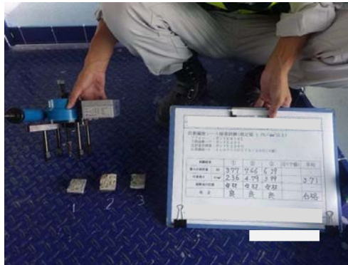
付着試験（試験片）
