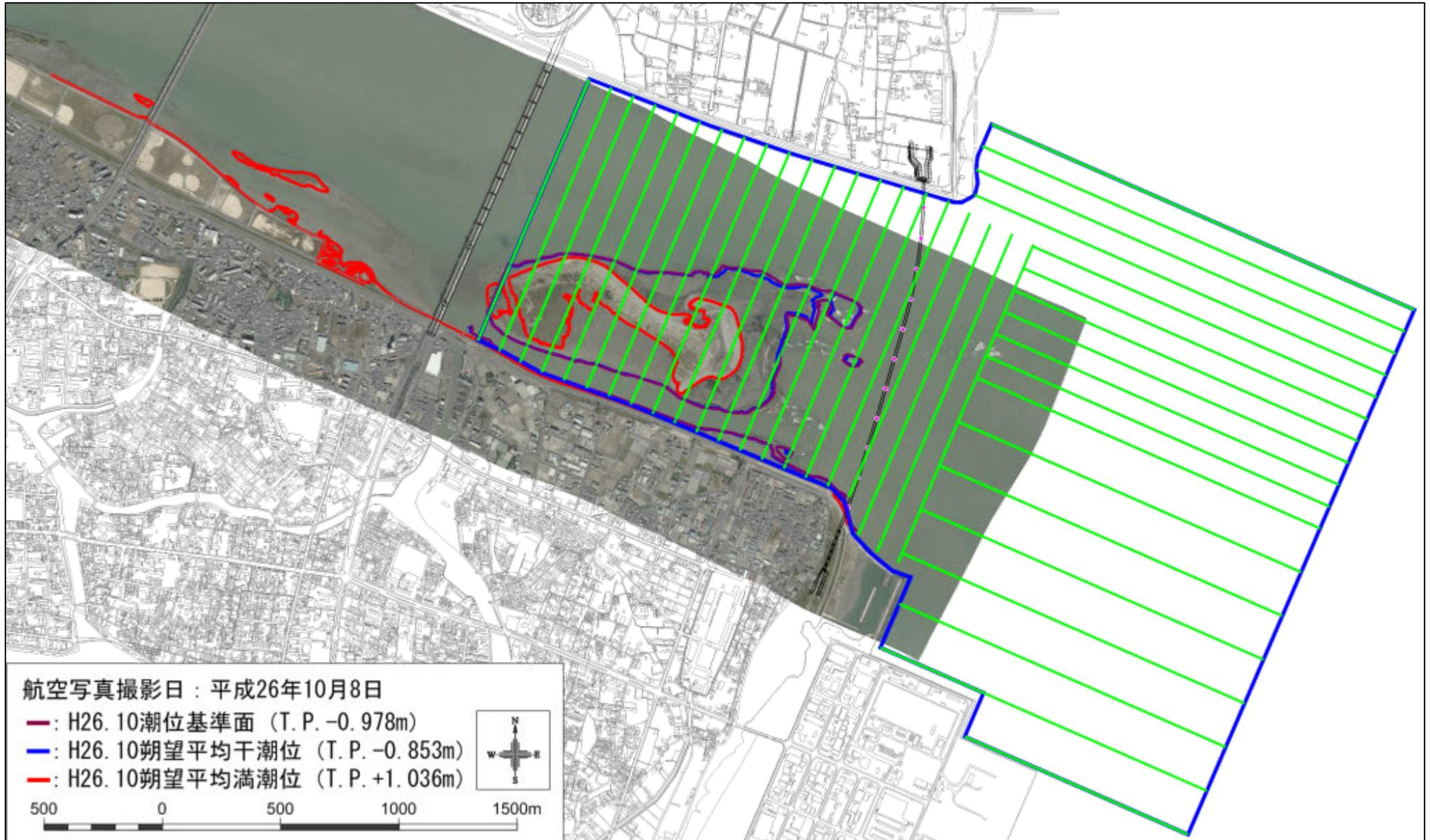
図 2-1 深浅測量範囲 (測線間隔 基本 100m ピッチ、沖合の一部 200m ピッチ)
