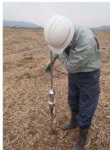
簡易動的コーン貫入試験状況
