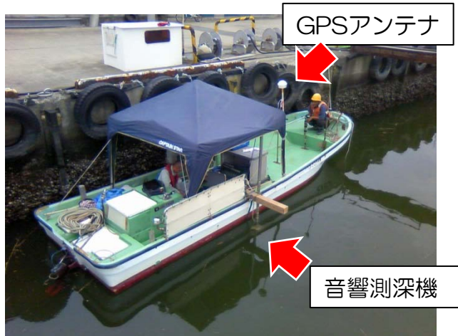
①操船し測線に沿って測量を実施
