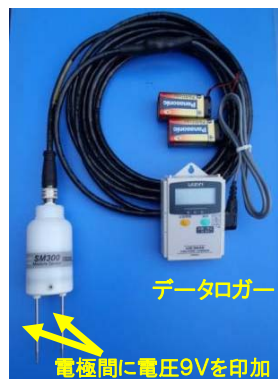
小型土壌水分計 (単深度測定)
