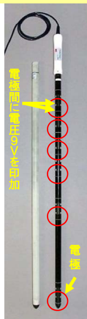
プロフィール型土壌水分計 (6深度測定)
