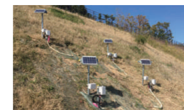
水分計現地設置写真 (切土や盛土内の土壌水分量を計測して、表層崩壊の発生を検知する)
