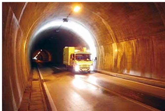
イーグル：走行しながらの撮影・高精度計測が可能（一般車両の走行を阻害しない照明を採用）
