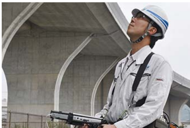
Jシステム：赤外線を使ったコンクリート診断
