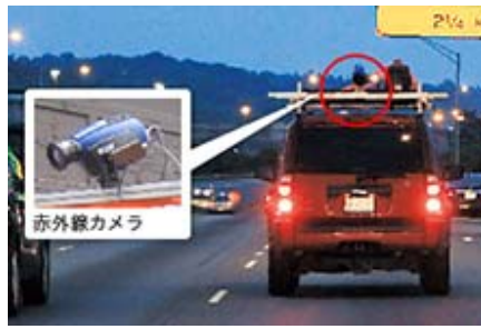
赤外線カメラによるコンクリート床版の撮影
