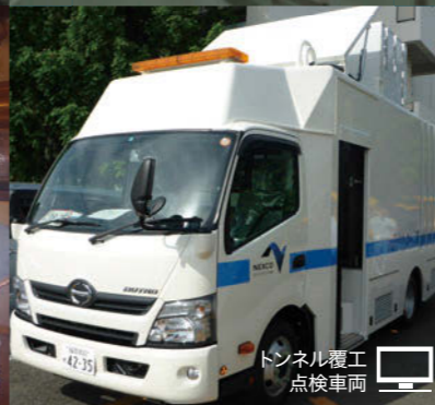
ラインセンサカメラを用いた トンネル覆工コンクリートの点検
