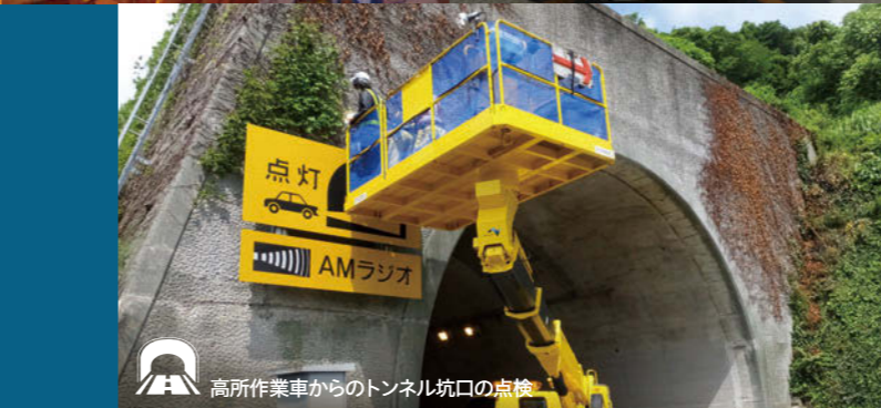
トンネル覆工 点検車両
