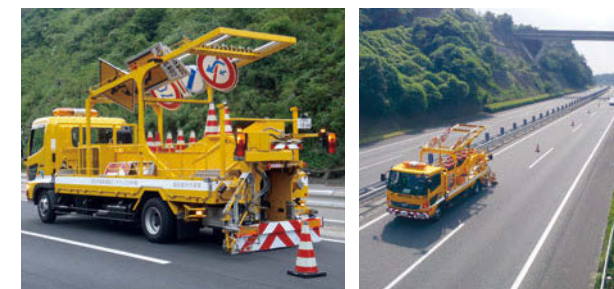
ロボコーン(ラバーコーン自動設置回収車)
