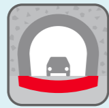
トンネル (インバート設置)
