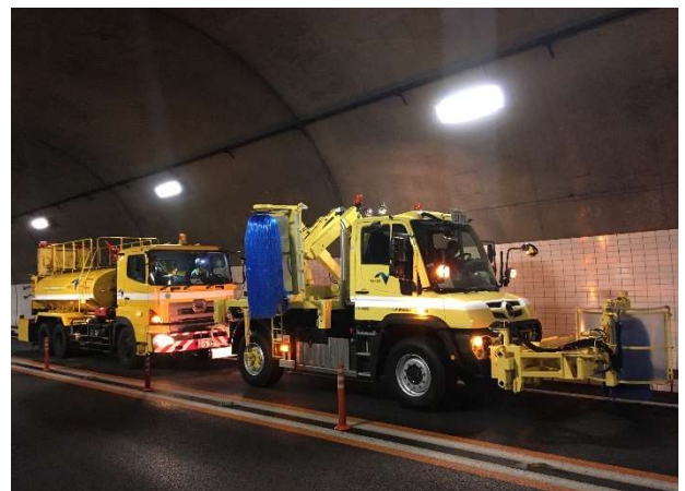
《トンネル側壁清掃》
