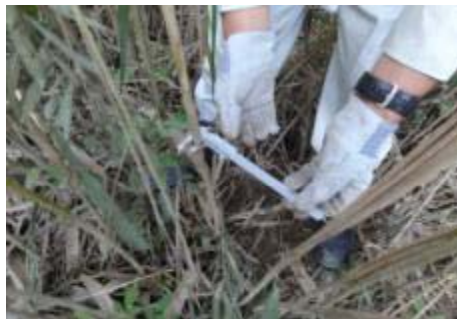
ヨシの直径の計測
