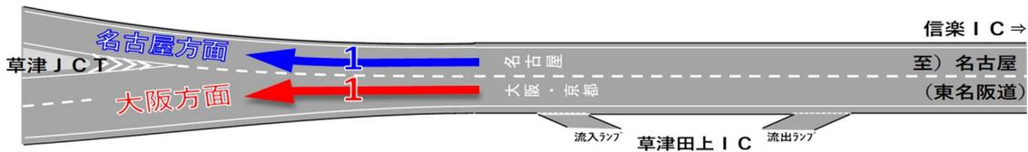
【対策後】大阪方面：2車線、名古屋方面：分岐ランプ方式 ※令和3年7月3日対策完了
