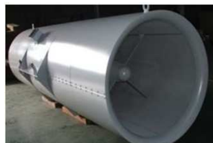
《トンネルジェットファン（補修後）》
