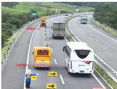
《工事規制矢印板・ラバーコーン自動設置・撤去車両（ロボコーン・ロボアロー）》
