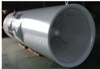
《トンネルジェットファン(補修後)》
