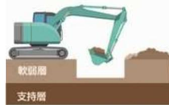
添加材を散布しバックホウにより混合
