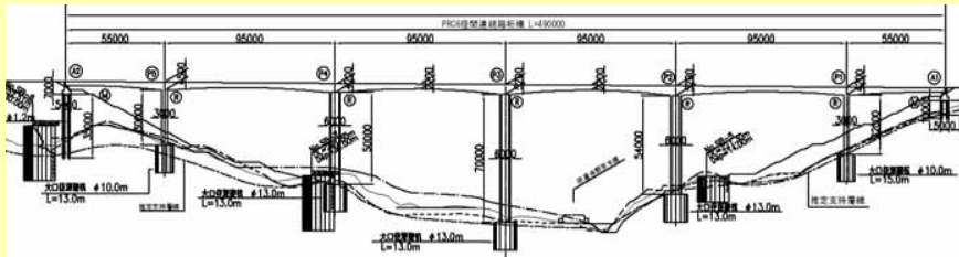
PC6径間連続箱桁橋
