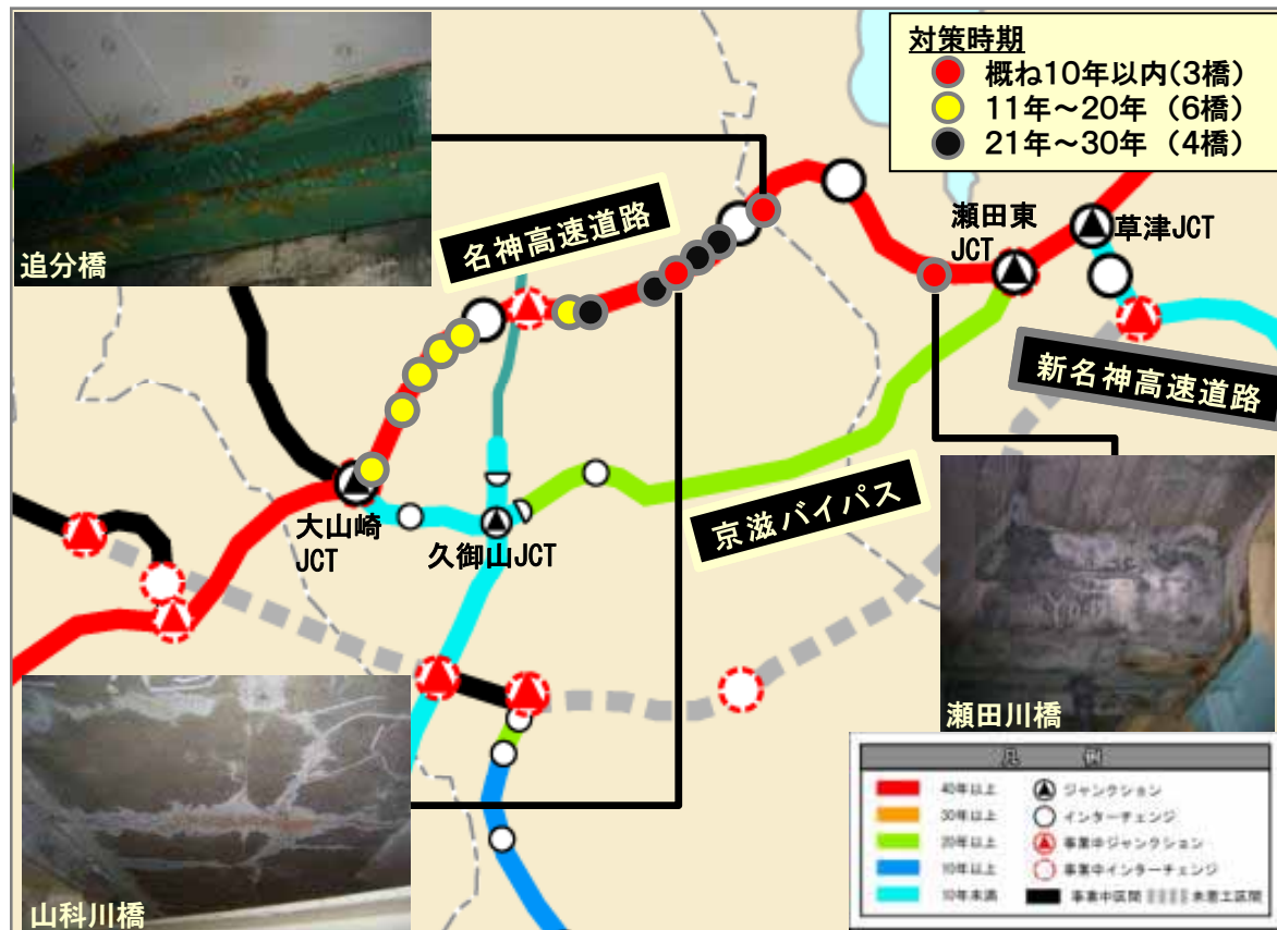
老朽化橋梁の補修が必要な名神高速
