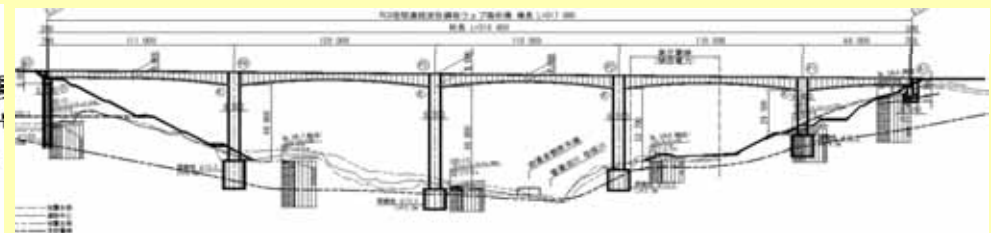
PC5径間連続波型鋼板ウェブ箱桁橋
