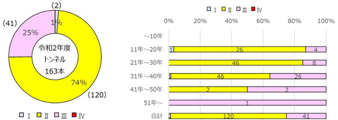
○判定区分と建設経過年度（トンネル）
