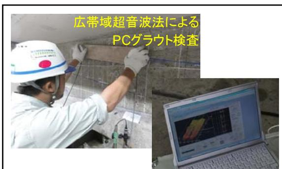
図 6.6.1 非破壊検査の例
