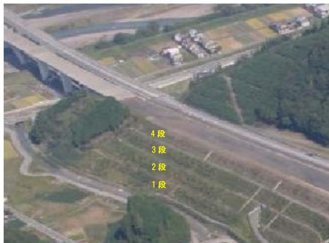
図 4.6.14 4段の盛土のり面の例
