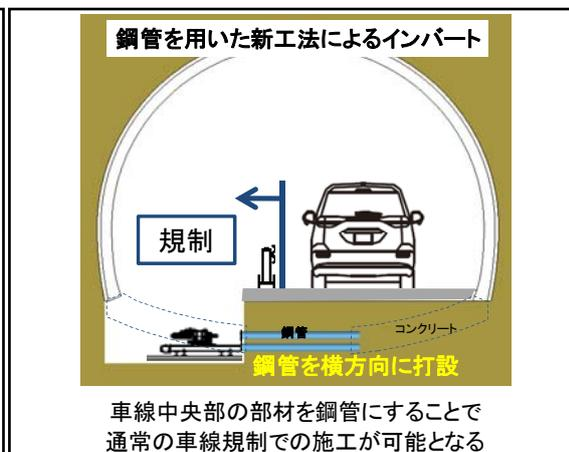
図 6.6.4 工期を短縮する急速施工技術の例
