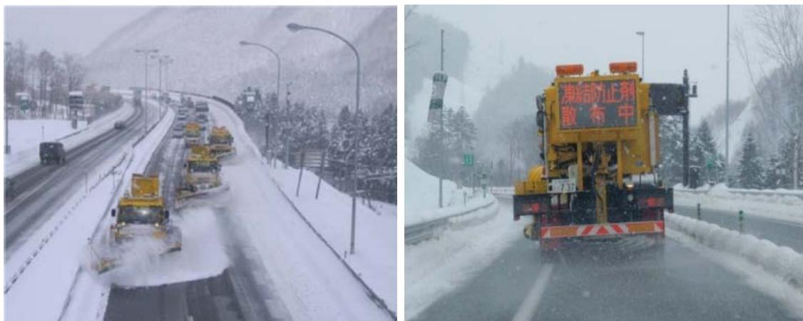
図 2.2.11 除雪及び凍結防止剤散布状況
