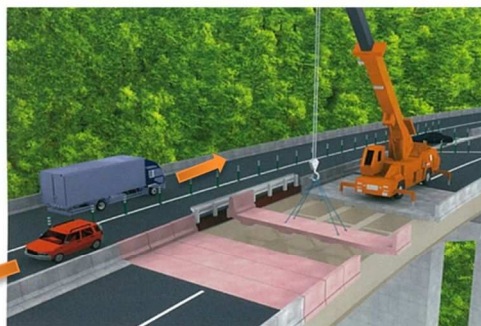
床版取替え工事のイメージ
