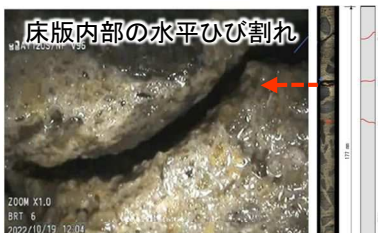
小径削孔調査結果
