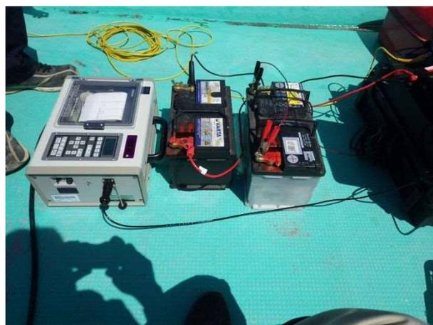
図 4.2-4 地形調査(深淺測量)の実施状況
