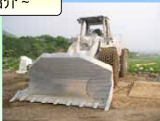
サイドダンプ：掘削した土をダンプトラックに積み込むための機械です。
