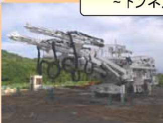
ジャンボ：トンネル掘削は火薬による発破掘削を行います。ジャンボは火薬を詰め込むために削孔する機械です。
