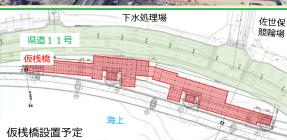
佐世保競輪場付近の佐世保高架橋 海上部に おいて、夜間に仮桟橋の設置作業を実施して います。その後、クレーンをこの仮桟橋上に 配置して昼間施工を行います。
