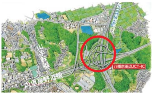
八幡京田辺 JCT 橋梁架設工事は第二京阪道路と国道 1 号線と立体交差する新名神高速道路と第二京阪道路を連結する JCT 工事であり、複数回に分けて実施され、現在は 4 つのランプ橋を含む、計 6 つの橋梁を架設する工事を行っています。
