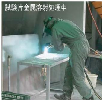
試験片金属溶射処理中
