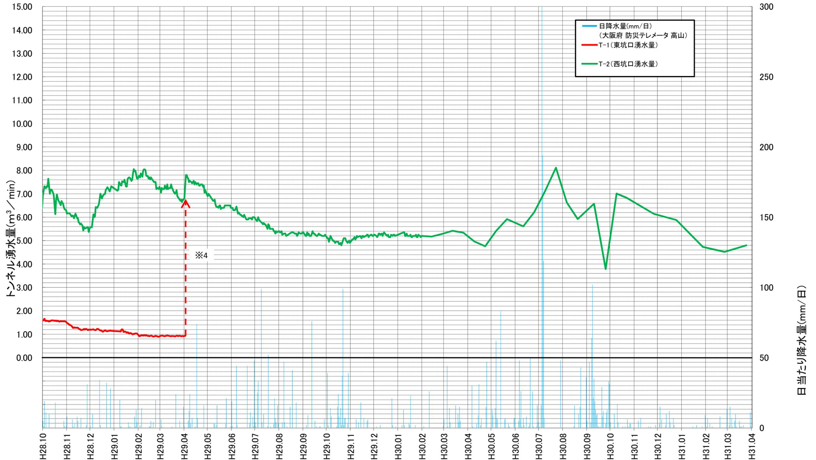
※4 トンネル排水工事の完成に伴い、平成 29 年 4 月より、トンネル湧水は、勾配の下流側（西坑口側）へ集約されました。
